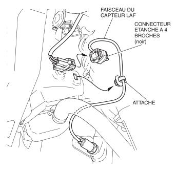
5. Déposez les bossages du carénage central droit, le tube de vidange et le capteur LAF de la même manière que pour le côté gauche.
