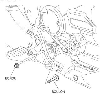
10. Protégez le bras oscillant avec un chiffon d'atelier ou un équivalent.
